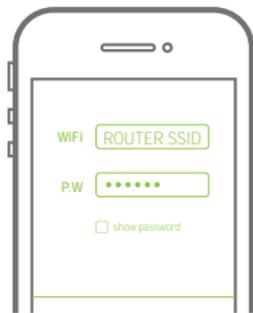
Assurez-vous que l'appareil mobile et le NEO soient connectés au même réseau Wi-Fi. Vous serez invité à saisir le mot de passe du réseau. Le processus de synchronisation prend environ 15-120 secondes et dépend des conditions de votre réseau Wi-Fi et de la longueur du mot de passe.
