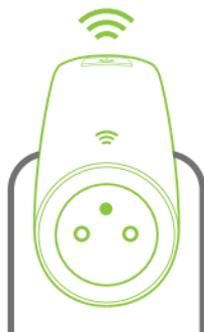
Branchez le NEO à une prise de courant, puis appuyez sur le bouton ON/OFF et maintenez enfoncé pendant 5 secondes. Relâchez le bouton lorsque le voyant Wi-Fi se met à clignoter rapidement. L'interrupteur NEO est maintenant prêt pour la synchronisation.
