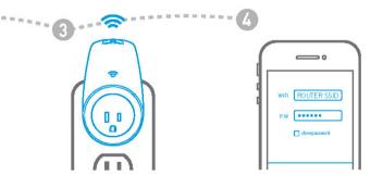
Enchufe NEO Interruptor a una toma de poder, a continuación, pulse el botón ON / OFF durante 5 segundos y suéltelo. El indicador Wi-Fi parpadea rápidamente. Interruptor de NEO está ahora listo para la sincronización
