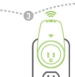
Enchufe NEO Interruptor a una toma de poder, a continuación, pulse el botón ON / OFF durante 5 segundos y suéttelo. El indicador Wi-Fi parpadea rápidamente. Interruptor de NEO está ahora listo para la sincronización.
